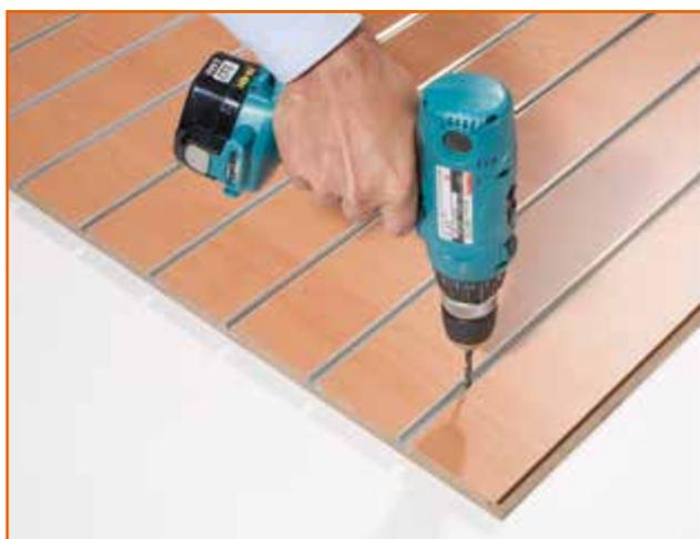
**1** Percer le panneau avec les inserts alu. (voir schéma de perçage au n°2)
